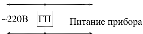
Рисунок Б.7 - Схема проверки устойчивости прибора к прерыванию и изменению напряжения питания
